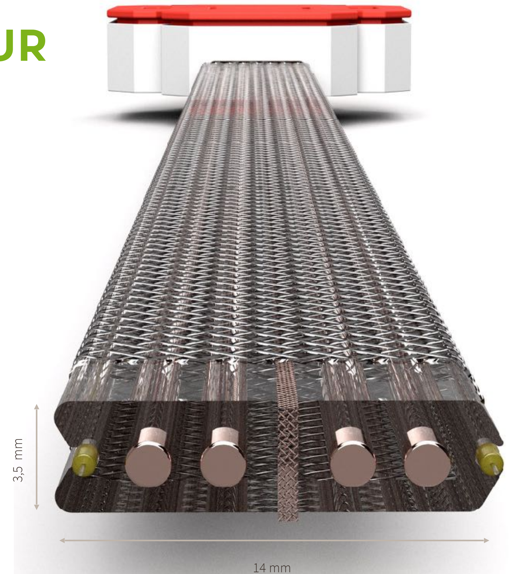
OmniCable mit 2 Glasfasern, 16 A DC, Erdung/Abschirmung und 16 A AC Der Abschirm-Schlauch aus verzinnem Kupfergeflecht ist optional
